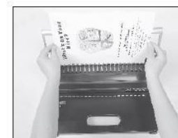
(Abb. 5) Schieben Sie die gelochten Blätter direkt auf den geöffneten Binderücken.
