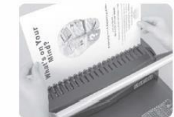
(Abb. 6) Schieben Sie die gelochten Blätter direkt auf den geöffneten Binderücken.
